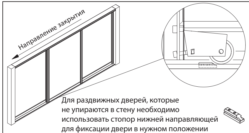
12_ Стопор нижней направляющей ( 10.01.031)
