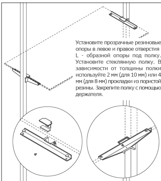
7_ Установите элемент для фиксации стекл. полки.
