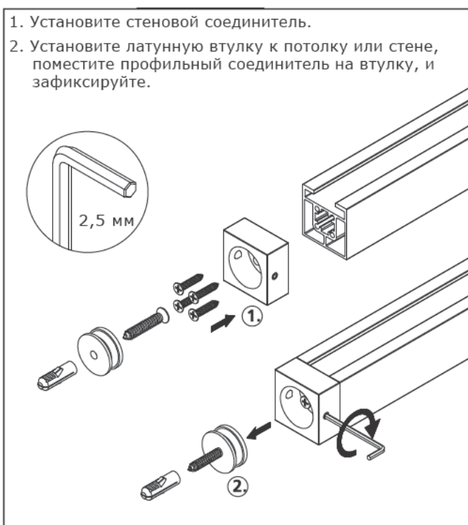
3_ Установка крепления к полу или потолку
