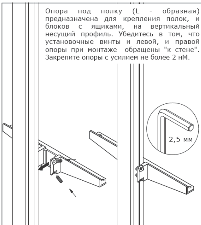
5_ Установите и зафиксируйте опору под полку.
