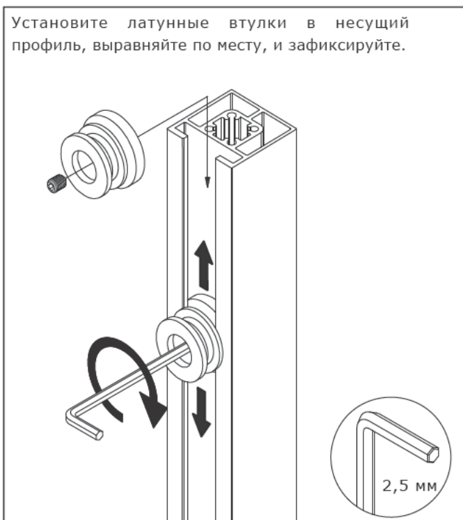
1_ Монтаж втулки для установки крепления
