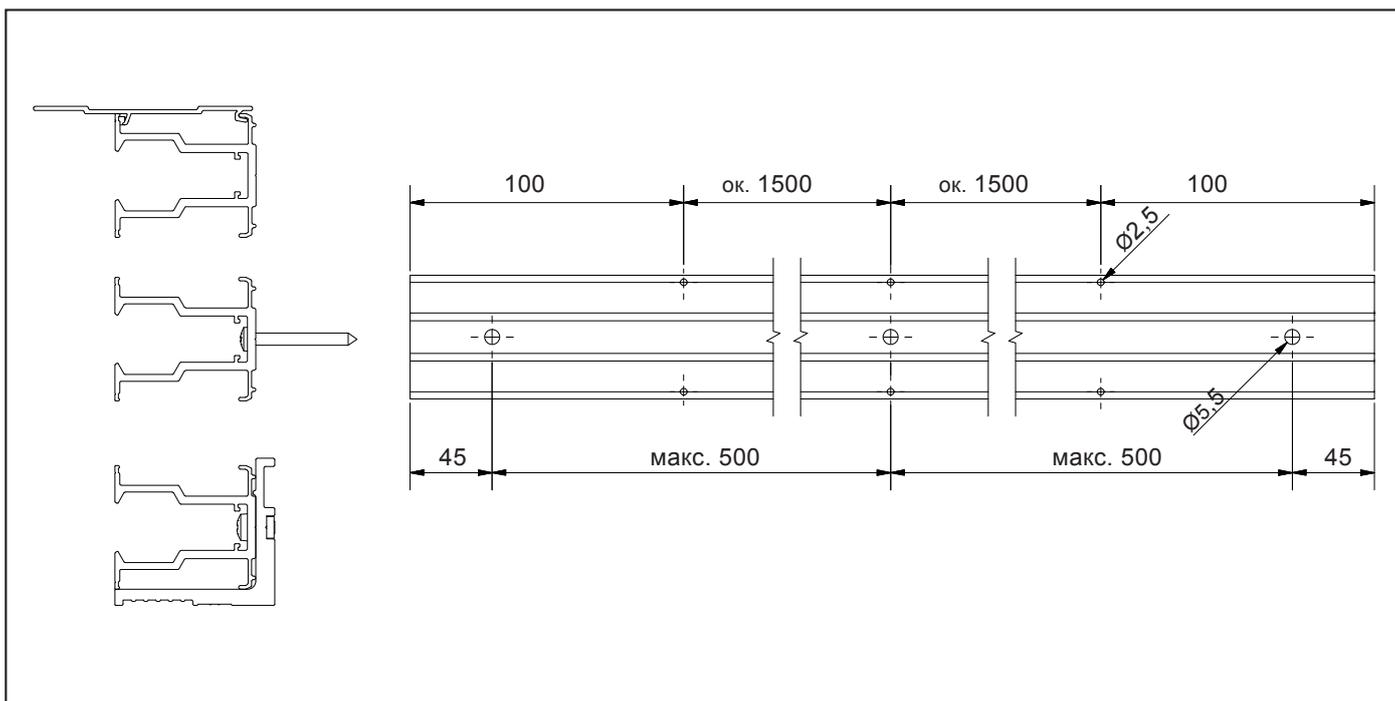
1\_ Отрежьте верхнюю направляющую необходимого размера, просверлите отверстия. Просверлите отверстия одновременно и в направляющей, и в стеновом профиле-держателе, если монтируете "перед стеной."
