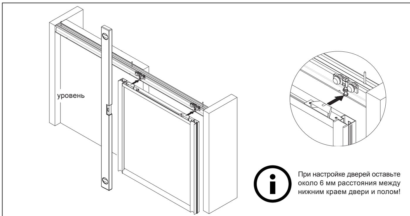
3\_ Отрегулируйте двери с помощью вертикальных винтов, но пока не затягивайте.
