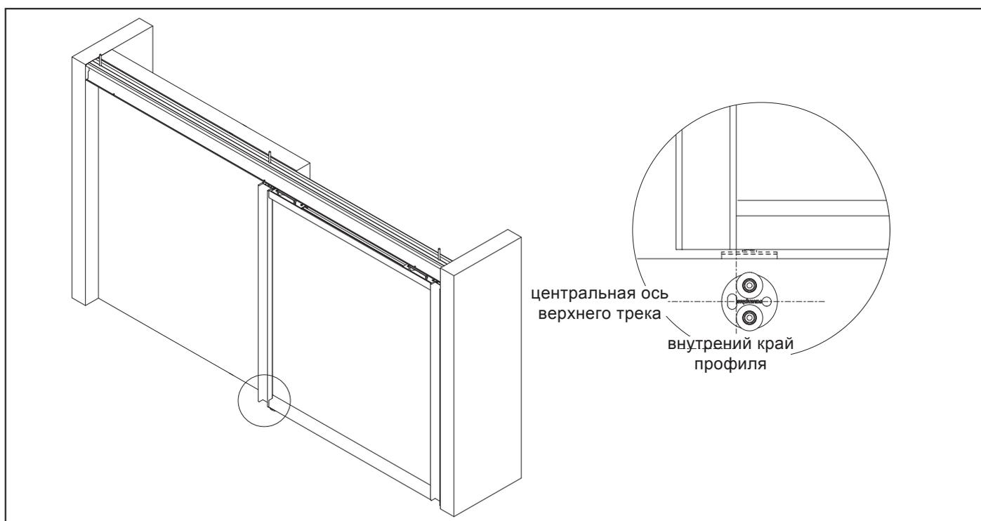
4\_ Отметьте положение нижних роликов (скотчем или карандашом), снимите дверь и закрепите нижние ролики.
