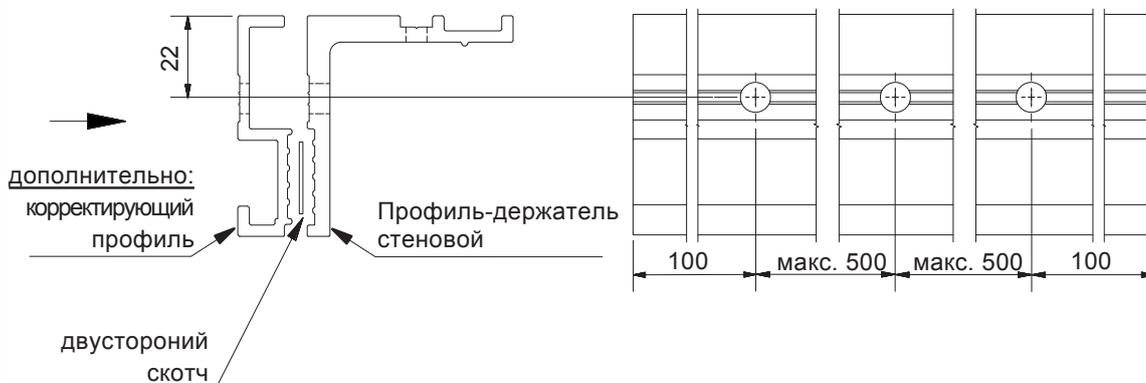
1\_ Схема отверстий профиля -держателя стенового и корректирующего профиля.
