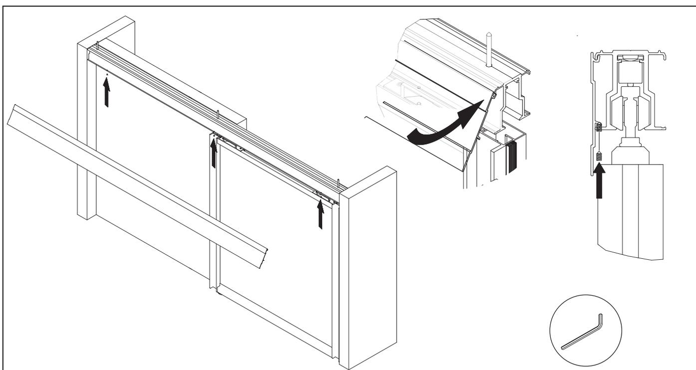
8\_ Установите накладку на верхнюю направляющую и закрепите её винтами.
